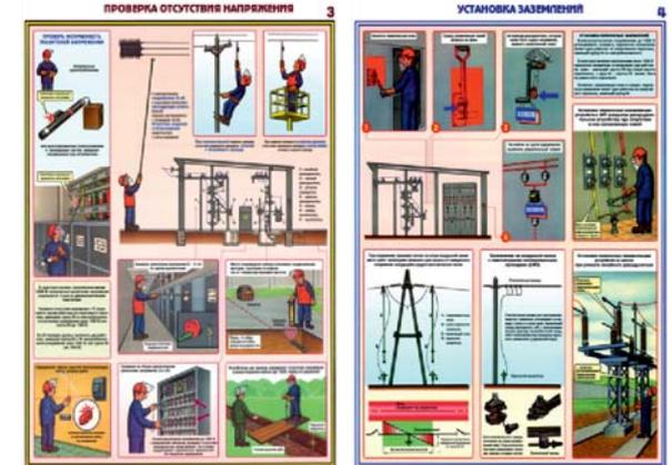
**Заземление и защитные меры электробезопасности (напряжение до 1000 В)**
